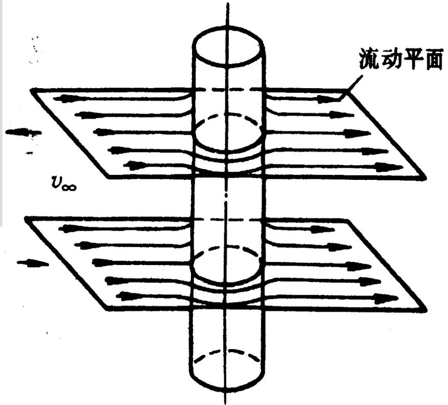
绕无穷长圆柱的流动
