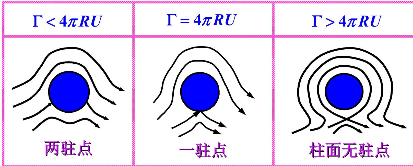
在闭合流线和圆柱面之间的内部区域自成闭合环流，但流线不是圆形
