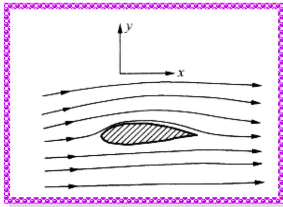
绕无限长机翼的二维流动
