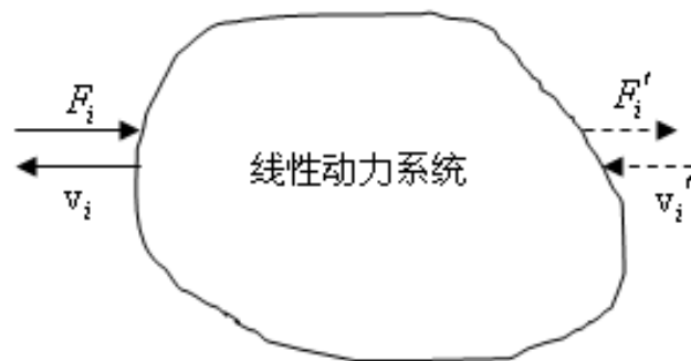
图 5.1 自由度为 n 的线性动力系统示意图
