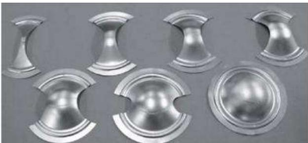
图 6 最少 5 种不同结构的试件，从窄条状到圆形
