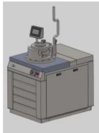
图 12 自研的 30 吨板料成形和杯凸试验机
