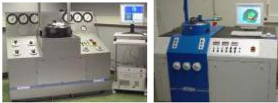
图 10 各种进口的杯突和板料成形试验机
