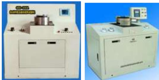
图 11 各种国产的杯突和板料成形试验机
