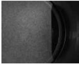
图 3 FLC 试验时板料表面只需喷涂散乱图案
