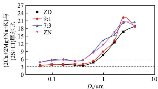
图5  $(2\text{Ca}+2\text{Mg}+\text{Na}+\text{K})/(2\text{S}+\text{Cl})$  摩尔比的粒径分布曲线
