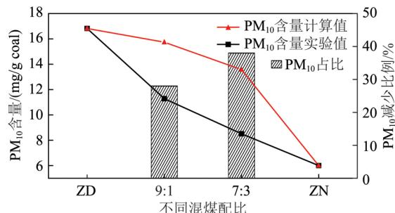
图3 不同配比混煤燃烧生成 PM<sub>10</sub>的实验值与加权计算值
