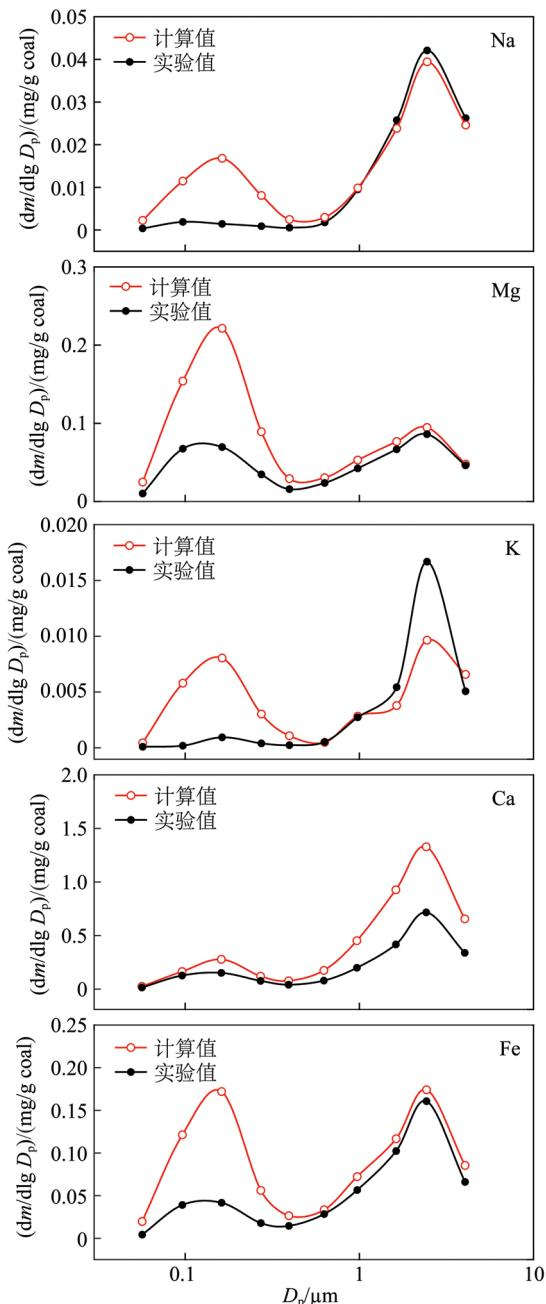
图6 混煤配比7:3时PM<sub>10</sub>主要元素的实验值与加权计算值的粒径分布
