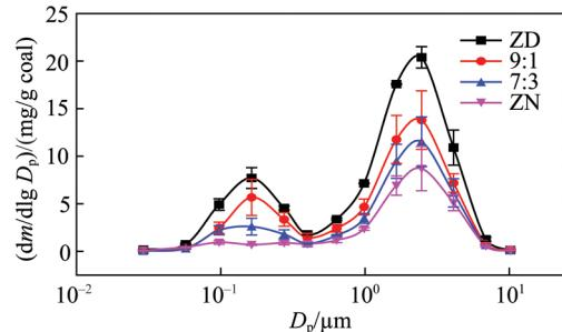
图2 纯煤与混煤燃烧 PM<sub>10</sub>粒径分布曲线
