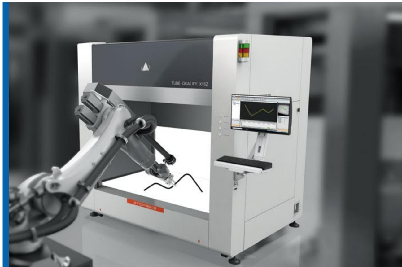
传统弯管零件检测主要依靠人工在检具上进行，测量时间普遍长达数小时，测量速度慢、数据不精确。同时，检具检测是一种接触式的检测方法，需要将管件卡在检具中，对高端管件的表面会造成划伤。在遇到、自由弯、连续弯的弯管时，传统管件测量方式无法适应。
