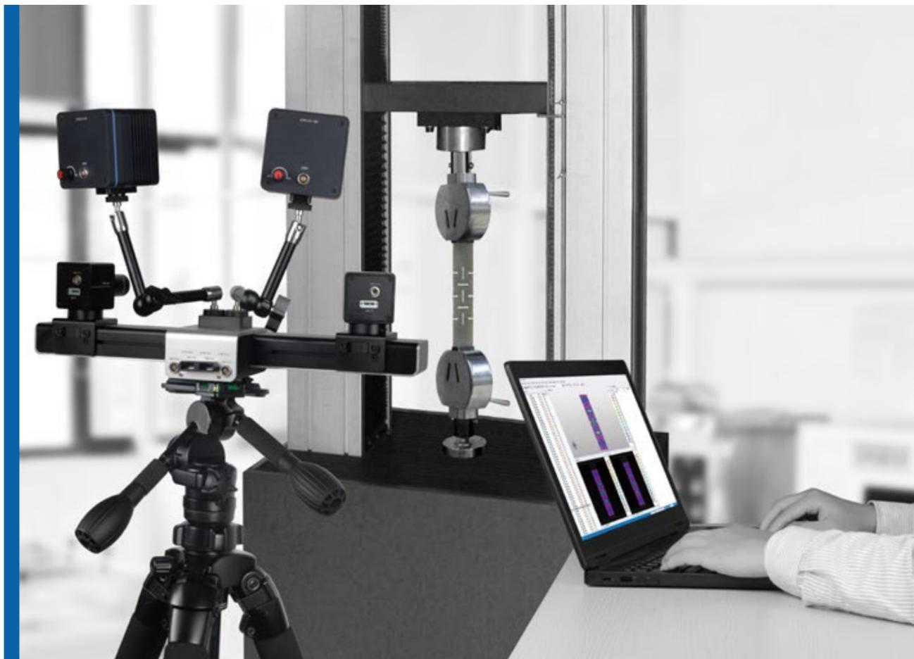
新拓三维XTDIC采用数字图像相关算法,为试验者提供高精度非接触式动态全场三维应变及位移测量。
