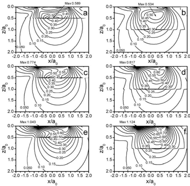
Fig.3 Contour plots of the von Mises stress in the  $y=0$  plane for  $E_f/E_b=2$ , (a) $\mu=0.25$ ,  $t=0.5a_0$ ; (b) $\mu=0.25$ ,  $t=a_0$ ; (c) $\mu=0.5$ ,  $t=0.5a_0$ ; (d) $\mu=0.5$ ,  $t=a_0$ ; (e) $\mu=0.7$ ,  $t=0.5a_0$ ; (f) $\mu=0.7$ ,  $t=a_0$
