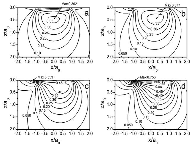
Fig.2 Contour plots of the von Mises stress in the  $y=0$  plane for  $E_f/E_b=1$ , (a)  $\mu=0.00$ ; 错误! 未找到引用源。 (b)  $\mu=0.25$ ; (c)  $\mu=0.50$ ; (d)  $\mu=0.70$
