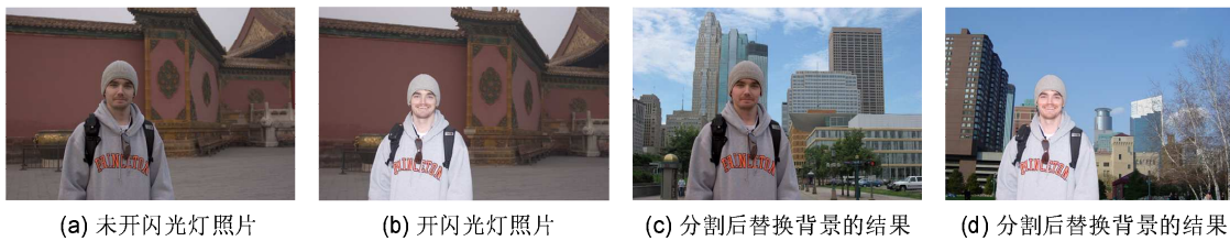
图 5-1 相机分别关/开闪光灯连续拍摄的两张图像的前景/背景分割后替换背景的结果。(a) 未开闪光灯的相片。(b) 开启闪光灯的相片。(c)(d) 应用前景/背景分割算法进行分割并替换背景的结果。
