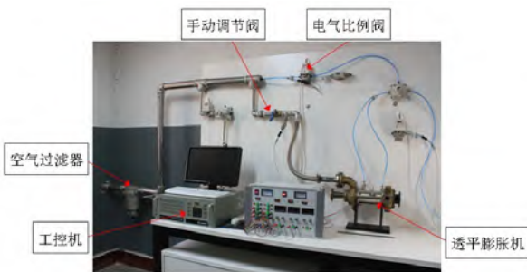
图 3 高速透平膨胀机轴承性能实验台
