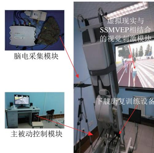
图 3 基于 SSMVEP 的主被动结合的下肢康复训练系统<sup>[113]</sup>
