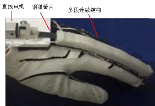
图1 多段连续结构外骨骼手功能康复机器人
