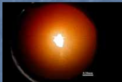
材料中心部分厚度1 微米左右
