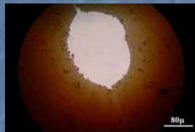
加速电压过高造成 的损伤
