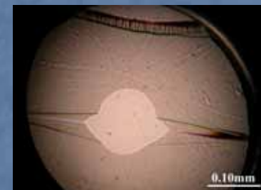
减薄前表面状态不 好，造成的损伤
