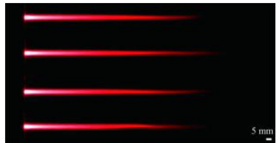
图9 试验中用高速相机(Nikon AF-MICRO 200 mm, 红色窄带滤光镜250 nm, 拍摄间距1/200 s)观察等离子射流瞬态形貌( I = 160 A, Q = 14 SLPM (70%N 2 +30%Ar)) [54]
