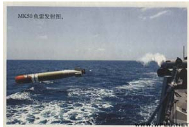
MK50 魚雷發射器。 160馬力雙迴路閉式循環汽輪發動機，航程大於20km，下潛深度大於800m，潛航速度為30節，戰鬥部裝填炸藥重40kg。
