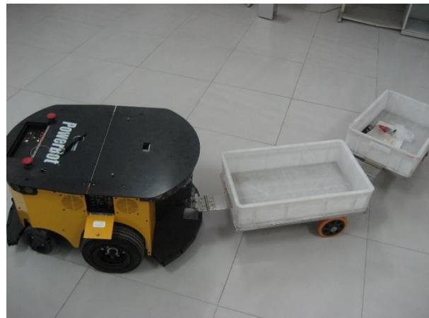
图 3.4 具有一节拖车的拖挂式移动机器人
