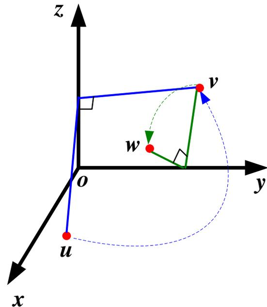
$$w = Rot(y, 90^\circ) \cdot v = \begin{bmatrix} c90^\circ & 0 & s90^\circ & 0 \\ 0 & 1 & 0 & 0 \\ -s90^\circ & 0 & c90^\circ & 0 \\ 0 & 0 & 0 & 1 \end{bmatrix} \begin{bmatrix} -3 \\ 7 \\ 2 \\ 1 \end{bmatrix} = \begin{bmatrix} 2 \\ 7 \\ 3 \\ 1 \end{bmatrix}$$
