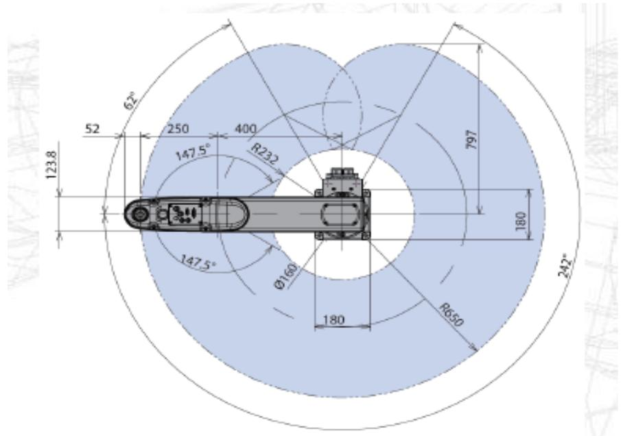
b) 串联多关节机器人 MOTOMAN MPP3S
