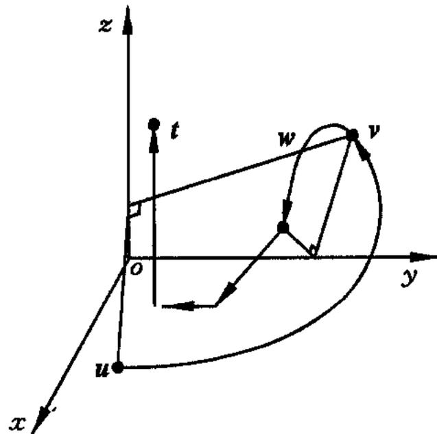
图2 平移变换与旋转变换的组合
