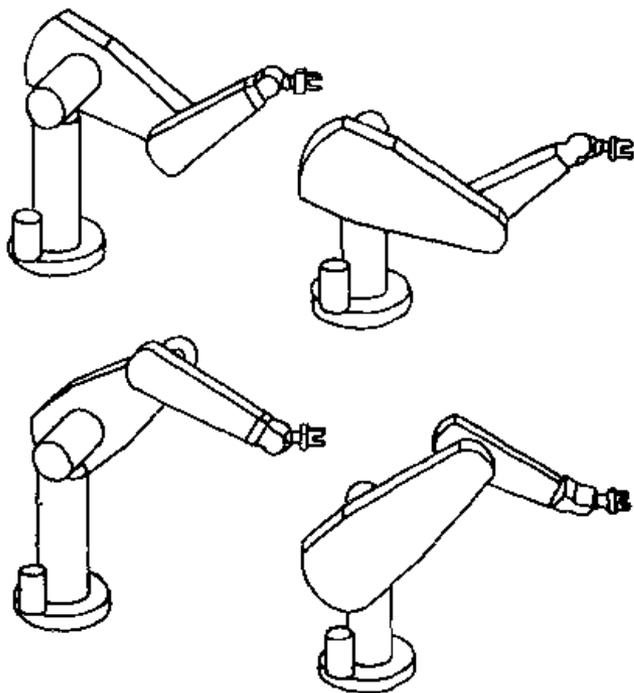
图 3-9 PUMA 560 机器人的四种运动学反解
