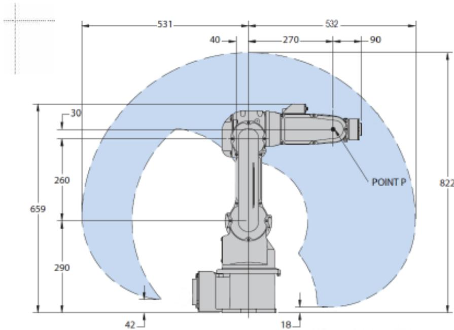
a) 串联多关节机器人 MOTOMAN MH3F
