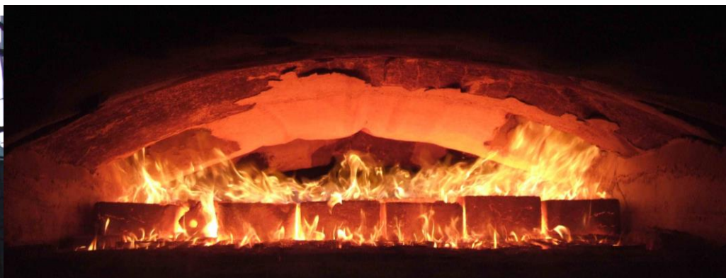
从炉排前部观察的商品型煤燃尽状态
