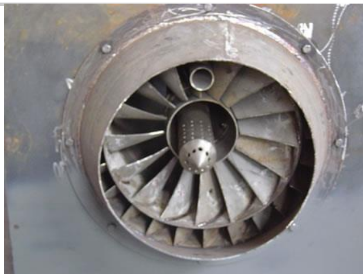
燃气燃烧器的旋流叶片
