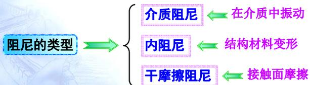
**粘性阻尼** → 振动速度不大时，由于介质粘性引起的阻力近似与速度一次方成正比
