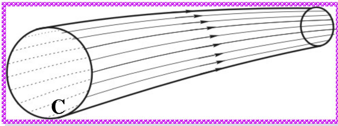
④ 流体不能从侧壁穿入穿出定常流动时，流管形状不变，类似于固定管道
