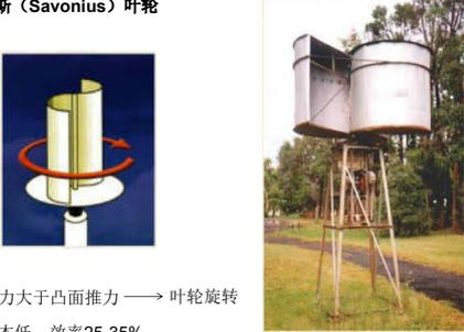
凹面推力大于凸面推力 → 叶轮旋转
