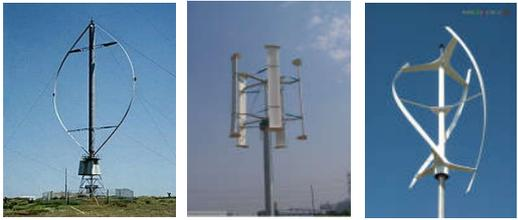
使用升力推动 (优于推力推动), 弯曲应力小、尖速比高无法自启动, 旋转受力变动
