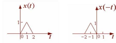
将信号的时移与反转相结合, 就可以得到  $x(-t \pm t_0)$  和  $x(-n \pm n_0)$ 。
