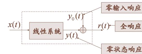
可见，增量线性系统的响应包括零输入响应和零状态响应两部分。
