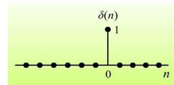
单位脉冲具有提取信号  $x(n)$  中某一点的样值的作用:
