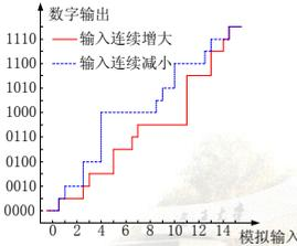
图3-8 正确工作情况下的A/D转换关系      图3-9 迟滞现象
