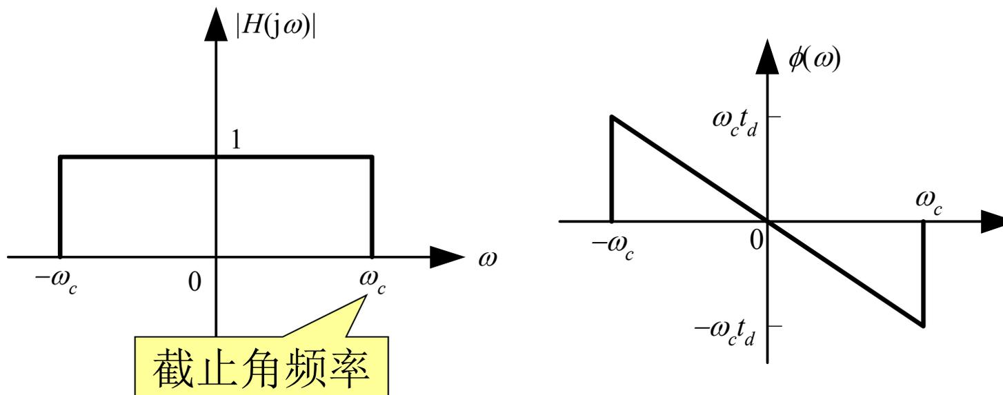
幅度响应 $|H(j\omega)|$ 在通带 $0 \sim \omega_c$ 恒为1，在通带之外为0。
