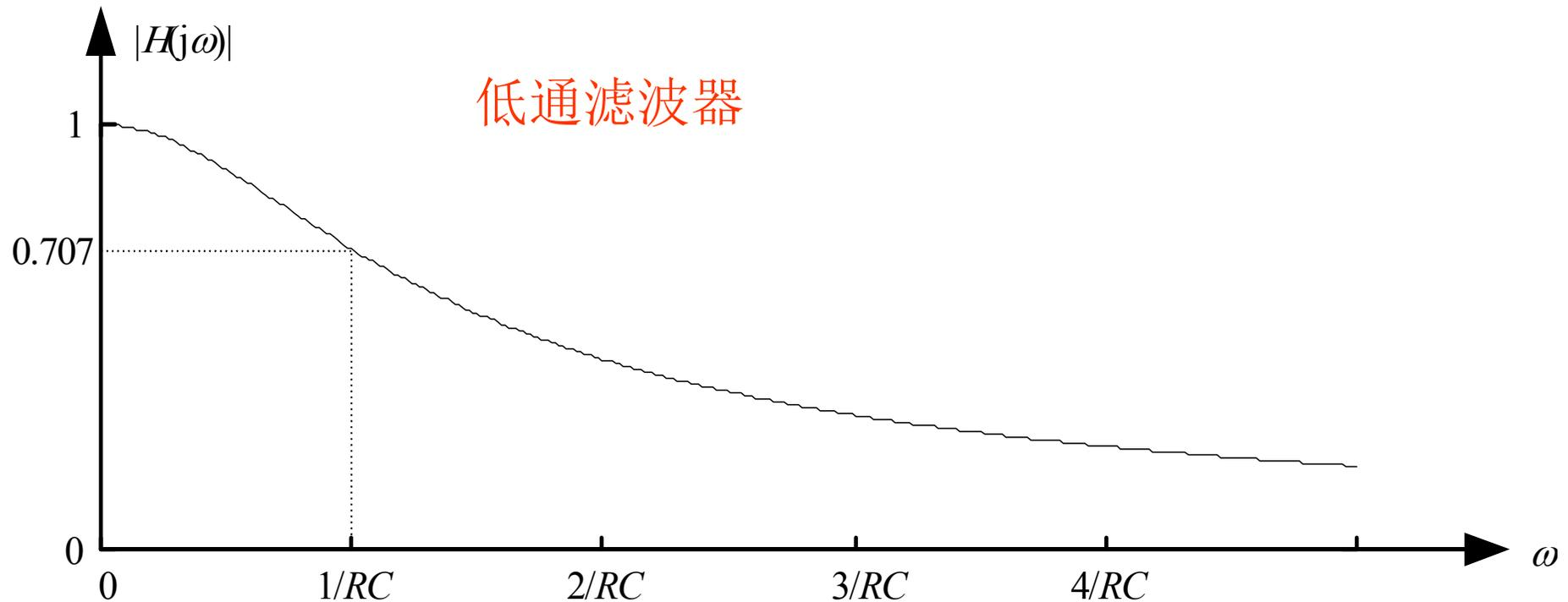
随着频率的增加，系统的幅度响应 $|H(j\omega)|$ 不断减小，说明信号的频率越高，信号通过该系统的损耗也就越大。
