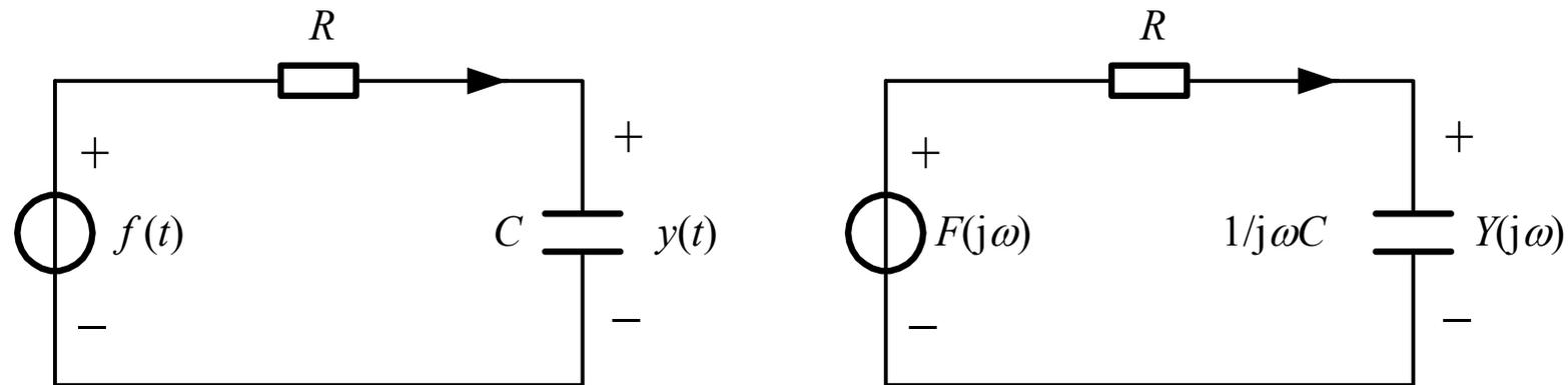
解：RC电路的频域(相量)模型如图，由电路的基本原理有
