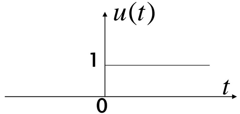
$$u(t - t_0) = \begin{cases} 1 & t > t_0 \\ 0 & t < t_0 \end{cases}$$
