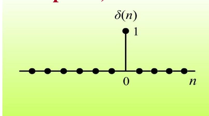
$\delta(n)$  具有提取信号  $x(n)$  中某一点的样值的作用。
