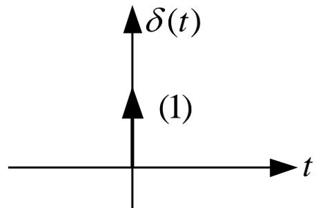
① 冲激信号具有强度，其强度就是冲激信号对时间的广义积分值。在图中用括号注明，以区分信号的幅值。
