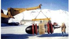
管道漏磁检测设备
