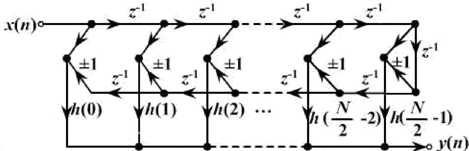
图5-27  $N$ 为偶数时, 线性相位FIR滤波器的直接型结构
