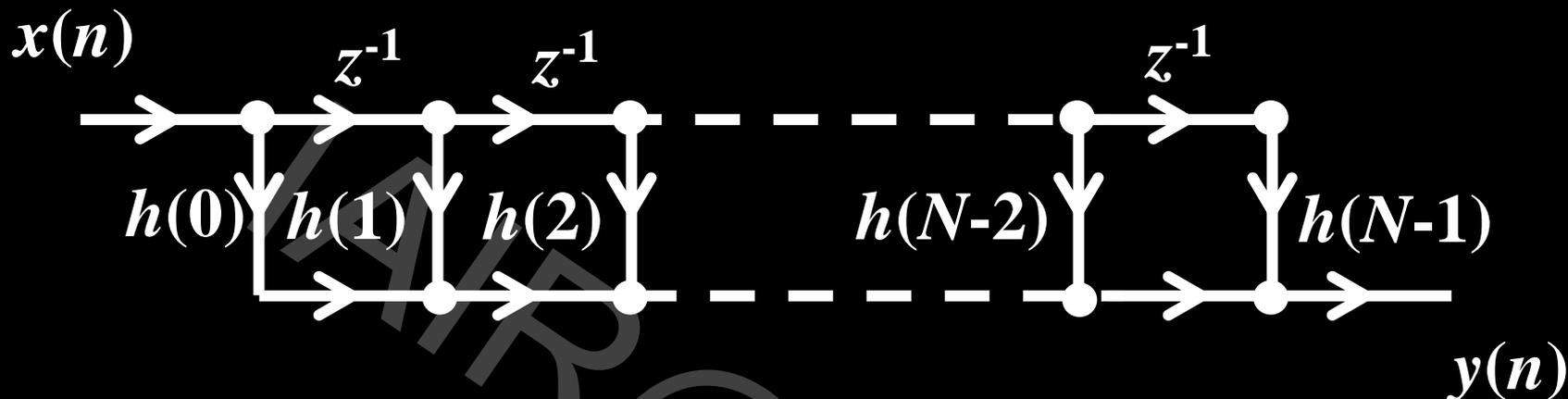
**转置定理:** 将原网络中所有支路方向倒转, 并将输入、输出互换, 则系统函数 $H(z)$ 不改变。
