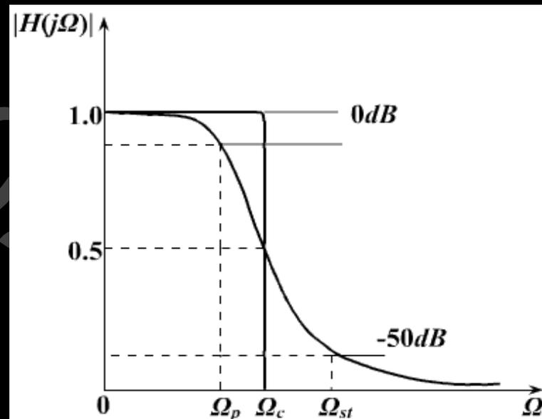
图7-14 例7-1要求的模拟低通滤波器特性
