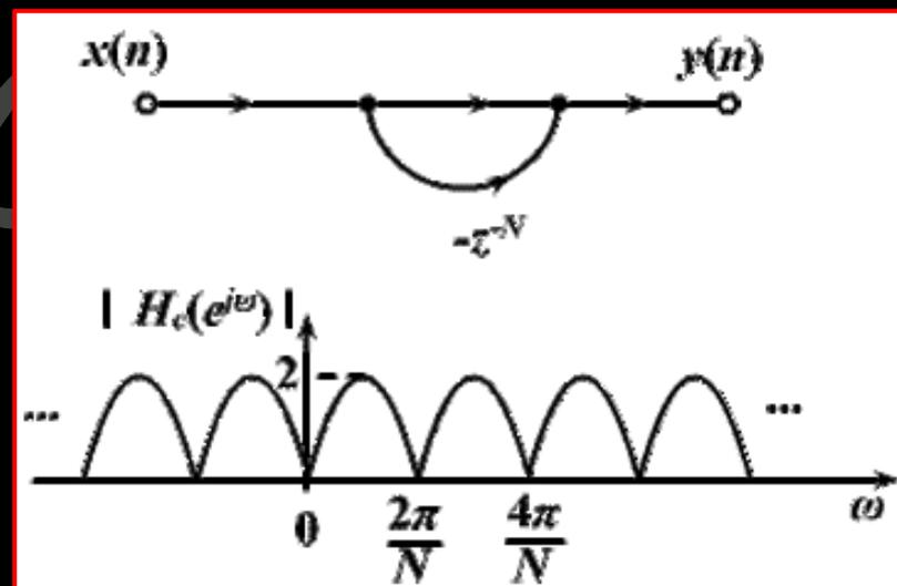
图5-18 梳状滤波器结构及频率响应幅度
