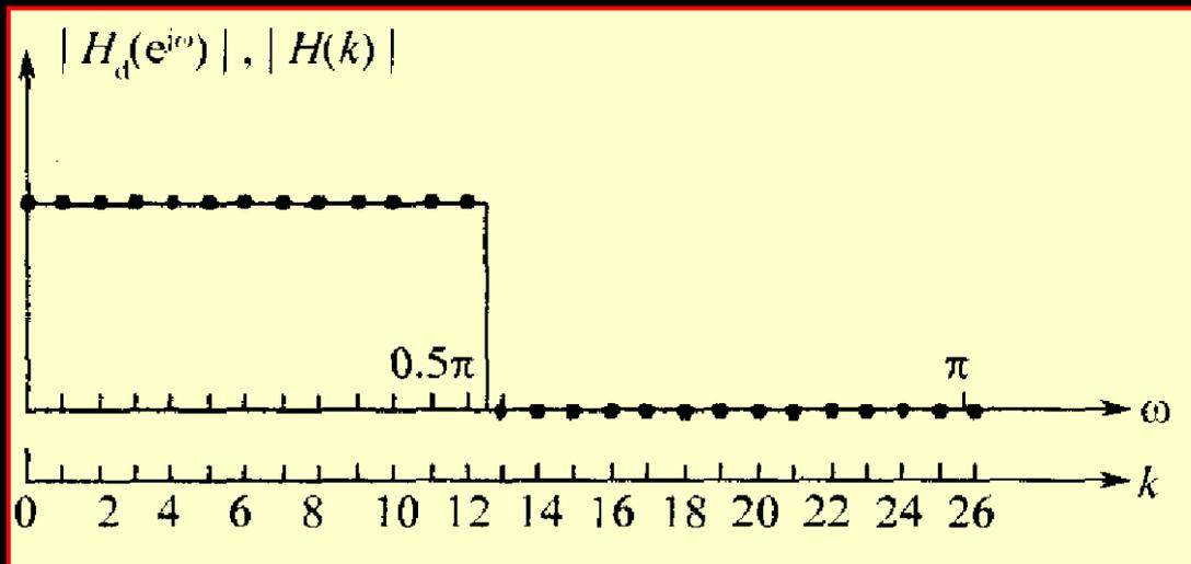
设计的滤波器 $20\lg|H(e^{j\omega})|$ 曲线
