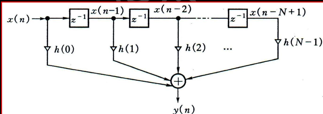
图 7.13 FIR 滤波器的非递归直接型结构
