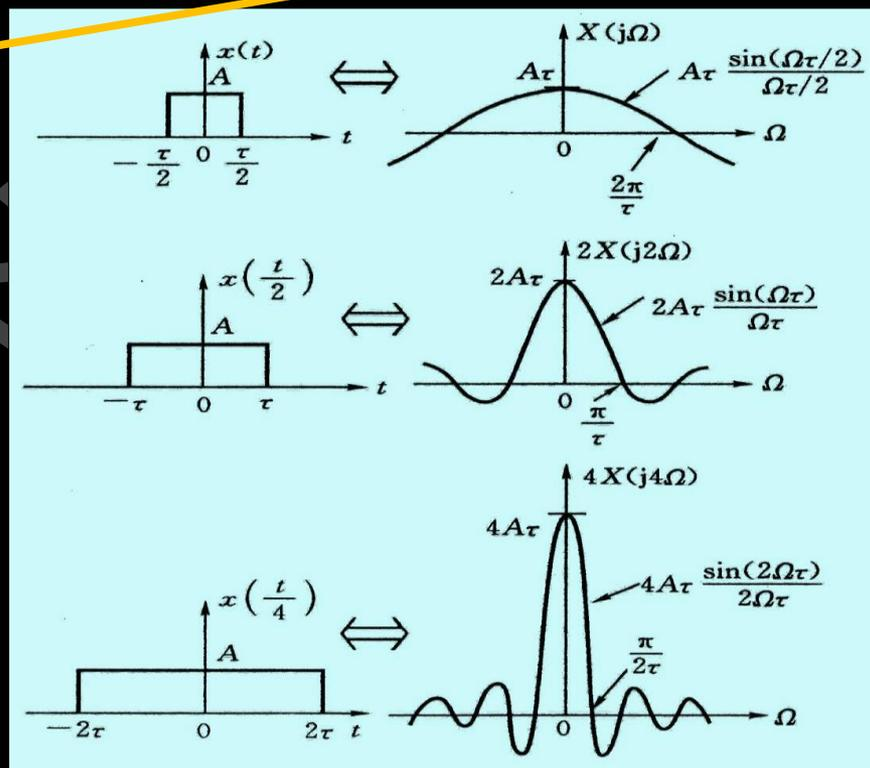
矩形脉冲信号的时间尺度变化导致频谱变化的图解
