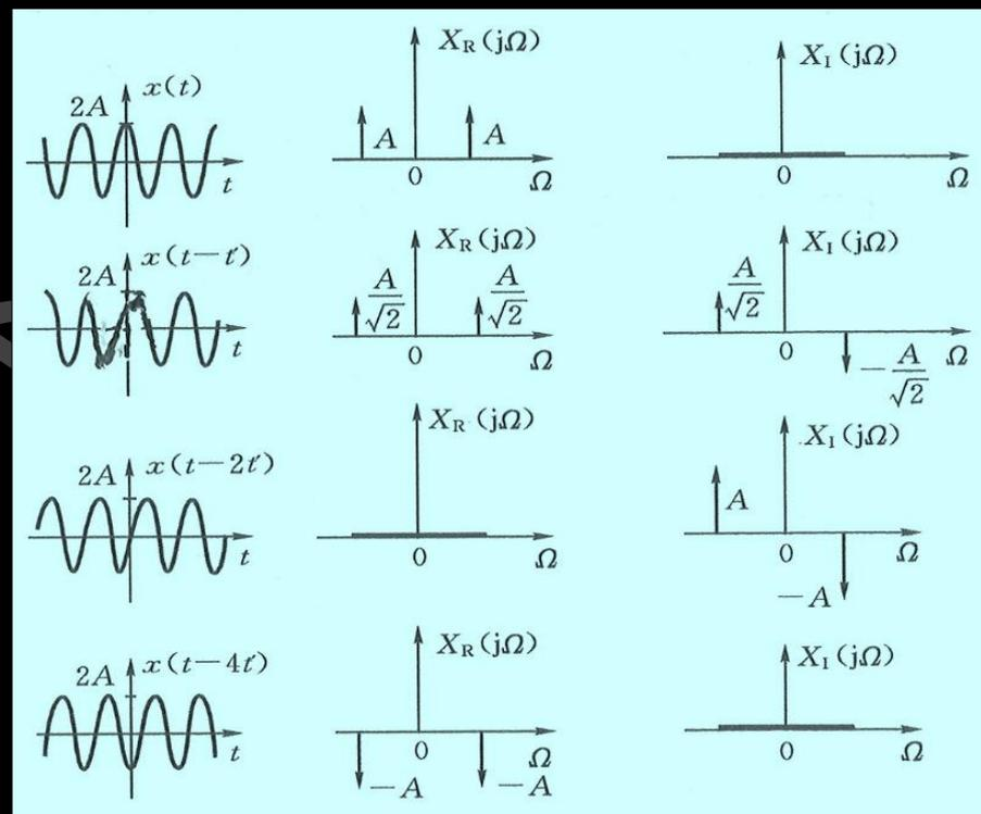
(时间移位 在频域中产生线性相移  $e^{-j\Omega t_0}$ )
