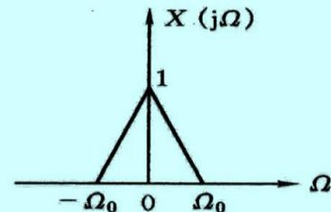
(a) 模拟信号  $x(t)$  的连续时间傅里叶变换
