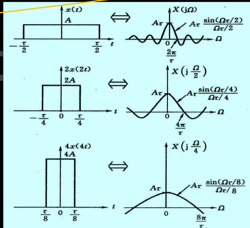
矩形脉冲信号的频率尺度变化导致时间尺度变化的图解
