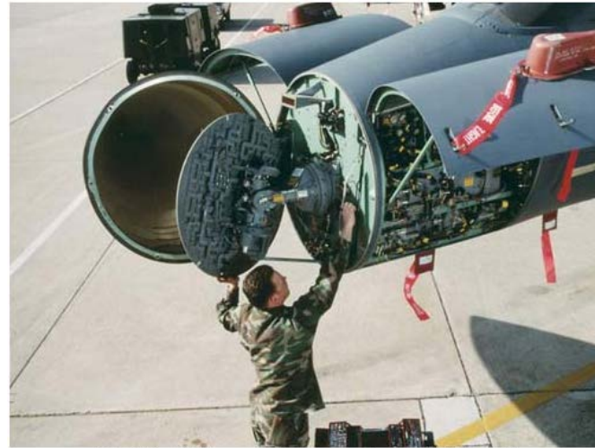
美军地勤人员检修F-15C战斗机APG-63(V)1有源相控阵雷达
